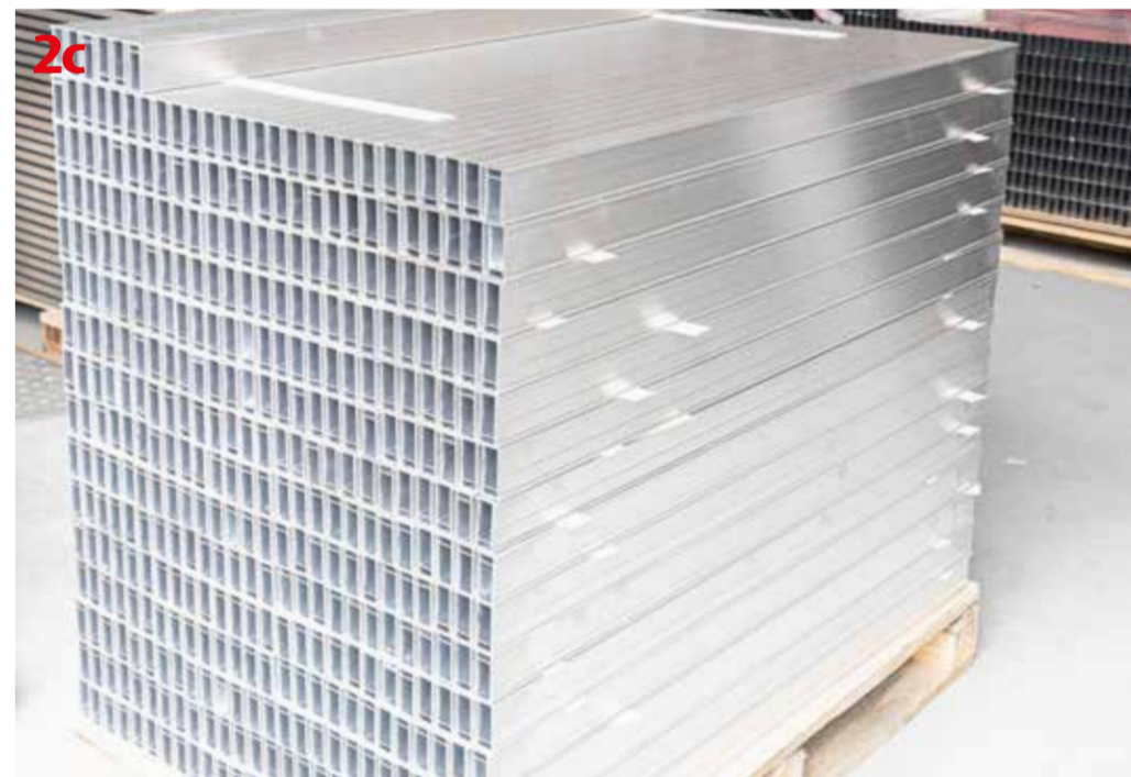
2c Wycięte profile poziomnic Powermax
