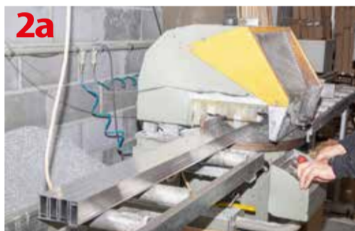
2a Operacja cięcia profili aluminiowych
