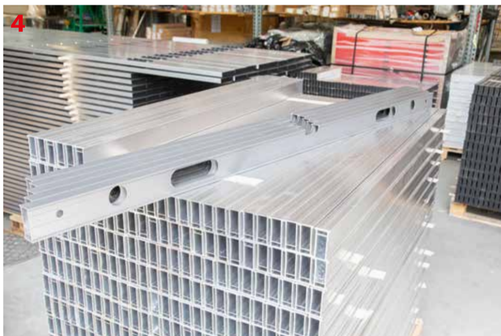
4 Profile poziomnic Powermax po malowaniu proszkowym
