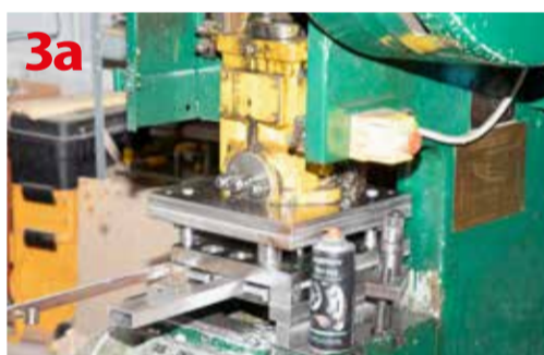
3a Operacja wytaczania otworów na libelle i rączkę
