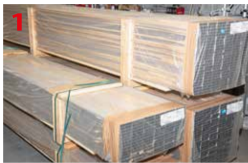
1 Material wyjściowy - aluminiowe profile
