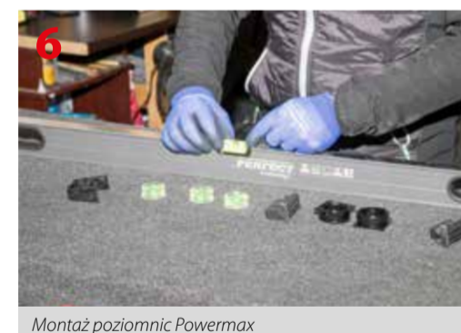
6 Montaż poziomnic Powermax
