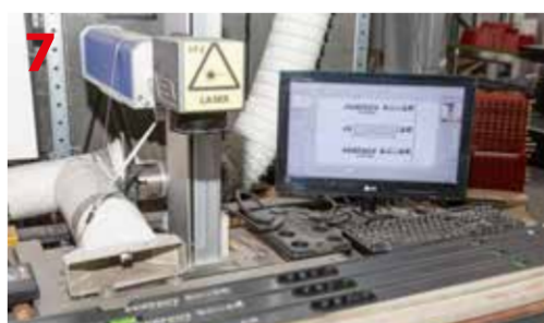
7 Operacja grawerowania laserowego poziomnic Powermax
